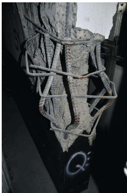
Slika 10a • Razprtje neučinkovito sidrane vodoravne armature na vogalih močno tlačno obremenjenih sten
