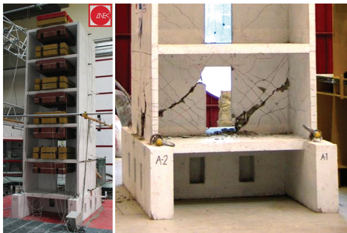
Slika 7. Test petetažnih sten s prirobnicami na potresni mizi v laboratoriju LNEC [Fischinger, Isaković in Kante, 2006].
